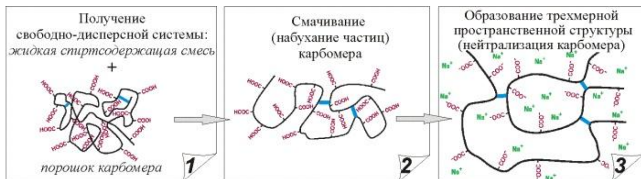
Рис. 1. Схема механизма гелеобразования в спиртсодержащих системах.
