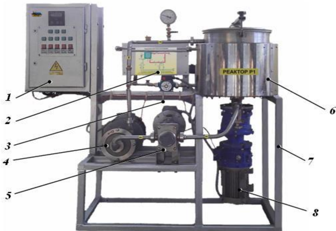
1 – пульт керування; 2 – електронагрівач; 3 – насос циркуляційний; 4 – дисково-циліндричний апарат типу АР-3000; 5 – насос роторний; 6 – ємність з перемішуючим пристроєм; 7 – рама; 8 – електродвигун перемішуючого пристрою
