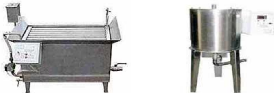
Рис. 2. Жиропонки (плавители) для пищевой промышленности.
