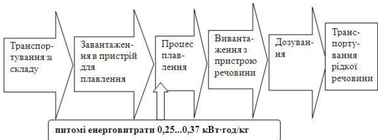
Рис. 1 – Традиційна технологічна схема плавлення в'язких речовин
