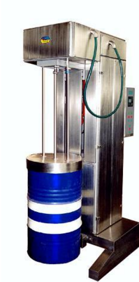
Рис. 6 – Загальний вид установки “Термобат-4,5” для прискороного плавлення в'язких речовин з низьким коефіцієнтом теплопровідності
